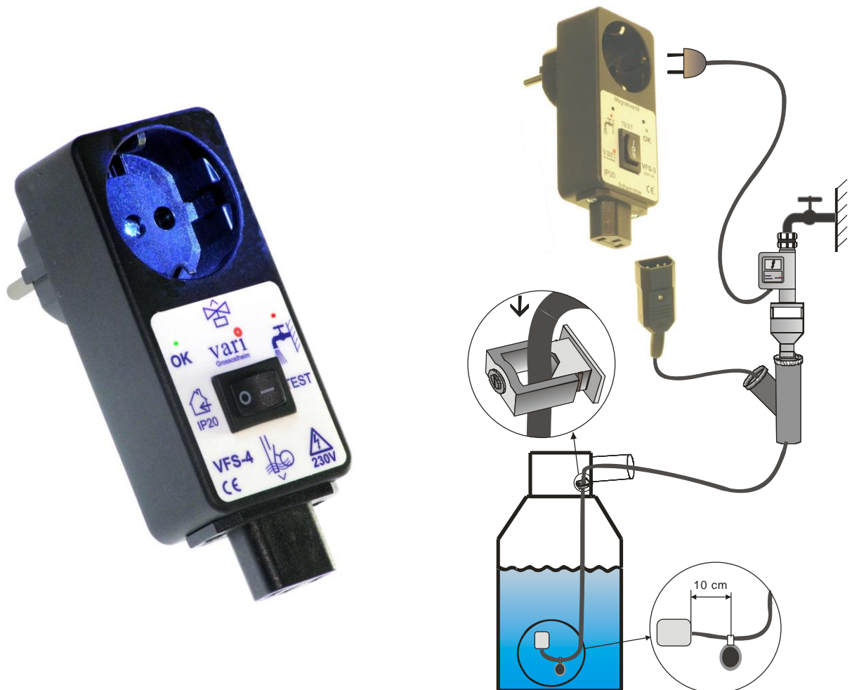
Abb. Schematischer Aufbau einer Regenwasseranlage, gesteuert mit einem VFS-4 Gerät.
